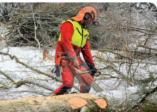
Beim ergonomischen und sicheren Entasten wird mit aufrechter Körperhaltung gearbeitet und die Motorsäge liegt auf dem Stamm auf. Vor dem Sägen ist auf sicheren Stand zu achten, dann ist die Säge immer mit Vollgas anzusetzen. Nie mit der Schwertspitze sägen.
