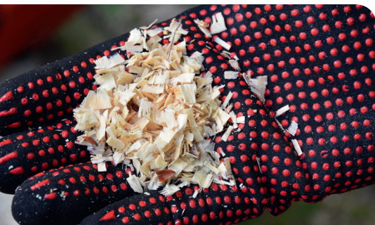
Eine gut geschärfte Sägekette produziert Sägespäne, eine Ungeschärfte produziert Sägemehl.
