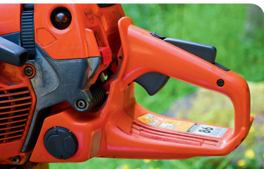
Die Gashebelsperre verhindert unbeabsichtigtes Betätigen des Gashebels.
