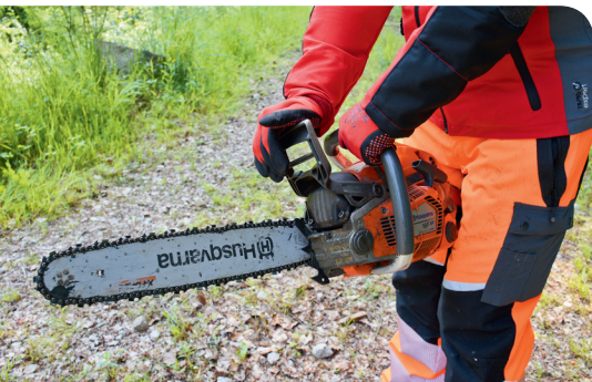
Die Kettenbremse muss die laufende Kette sofort stoppen.
