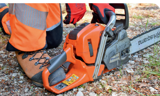
Startposition mit Sicherung am Boden.
