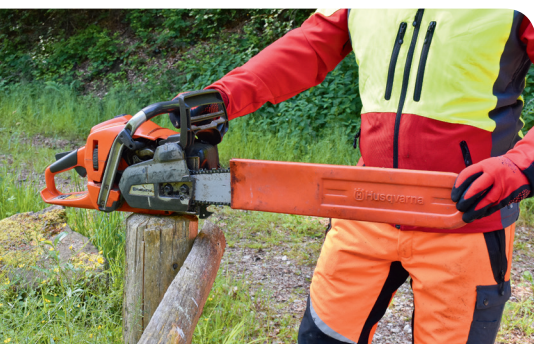
Der Kettenschutz gehört immer zur Kettensäge
