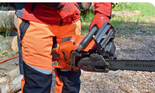
Startposition mit Sicherung zwischen den Oberschenkeln.
