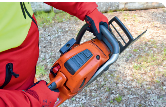
In seitlicher Griffposition löst der Kettenstop bei einem Kick-Back nicht aus.
